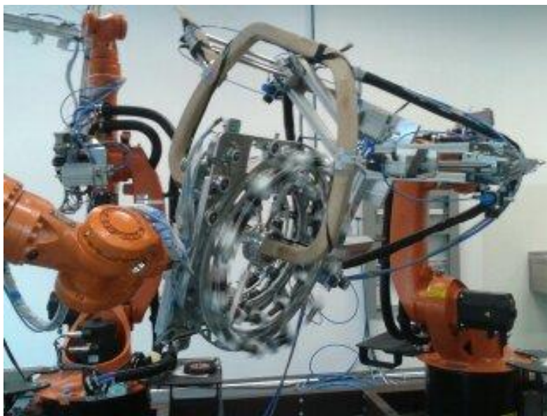
Obr. 10 Robotické pracoviště přesného vinutí.
