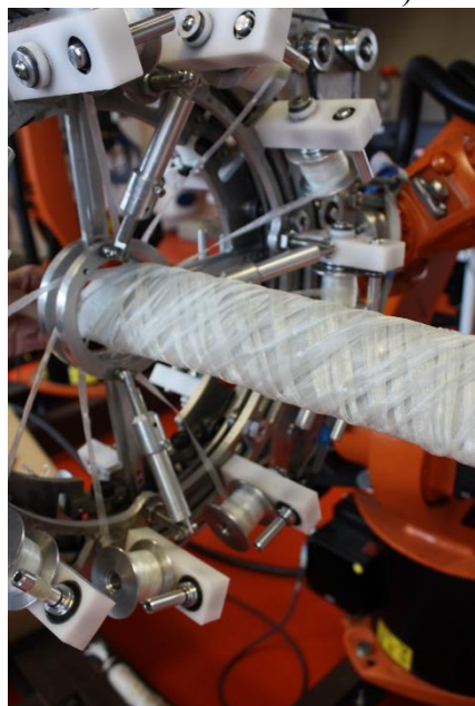
b) Kladení pásku pod úhlem 45°
