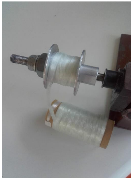
Obr. 2 Ruční převíjení hybridní pásky na cívku pro ovíjecí hlavu.
