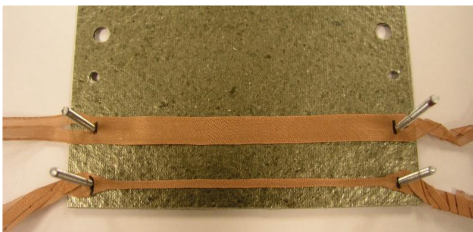
Obr. 1: Příprava elektrod před slepením desek
