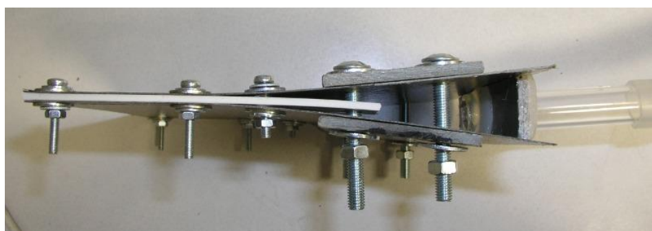
Obr. 2: Sestavení trysky před vlastním lepením
