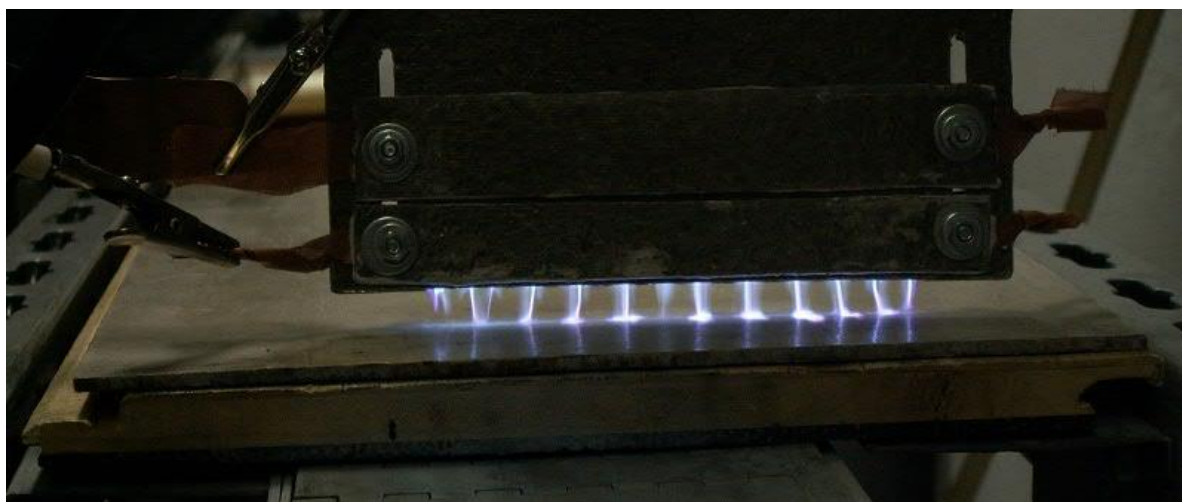
Obr. 12: Konstrukce trysky ze slídových desek tloušťky 0.5 mm, desky v oblasti výboje rovnoběžné, štěrbinu šířky 2 mm, délky 100 mm, průtok pracovního plynu 50 l/min, výkon 250W – vloženy vlnité výztuhy ze slídové desky, typ F500P – detail výboje při ústí trysky
