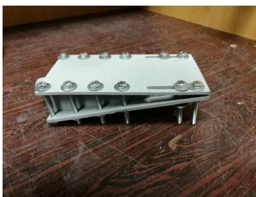
Obr. 14: Výsledná konstrukce trysky vyrobená pomocí 3D tisku
