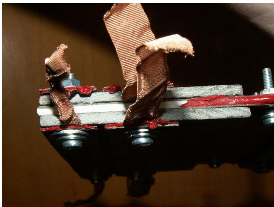
Obr. 4: Lepená tryska - detail uchycení elektrod
