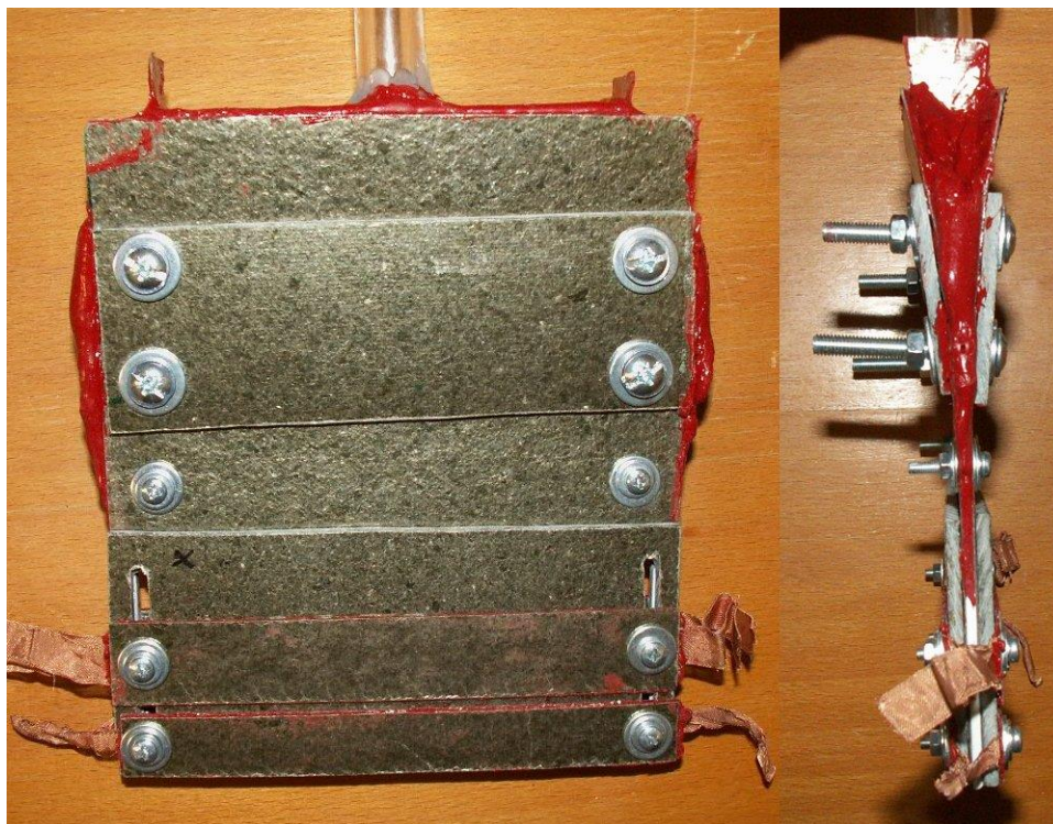
Obr. 3: Lepená tryska - varianta s posuvnými, odnímatelnými elektrodami
