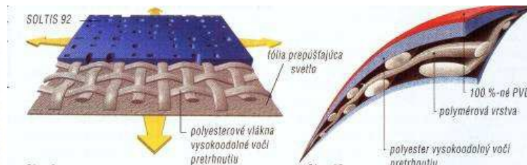
Obr. 9. Detail skladby štruktúry membrány SOLTIS 92 so svetlopriepustnou membránou, výrobca Ferrari SA (patent Ferrari Précontraint)
