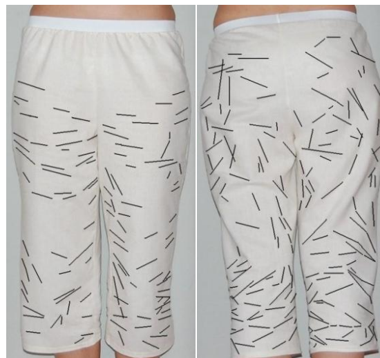
Obr. 11. Zmačkání textlie U1 – tvorba záhybů při reálném užívání výrobku
