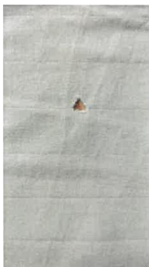
Obr.9 Díra a přetrh bavlny
